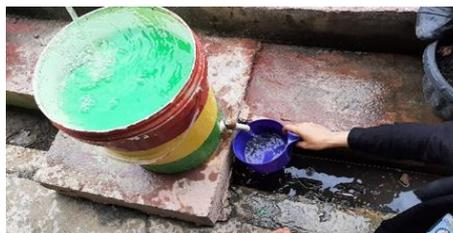
**Gambar 1.** Dokumentasi pengujian media filtrasi air sederhana menggunakan arang ketapang
